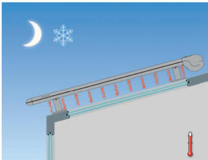
2. Reduzierung des Strahlungsaustausches durch Sonnenschutzbehänge
